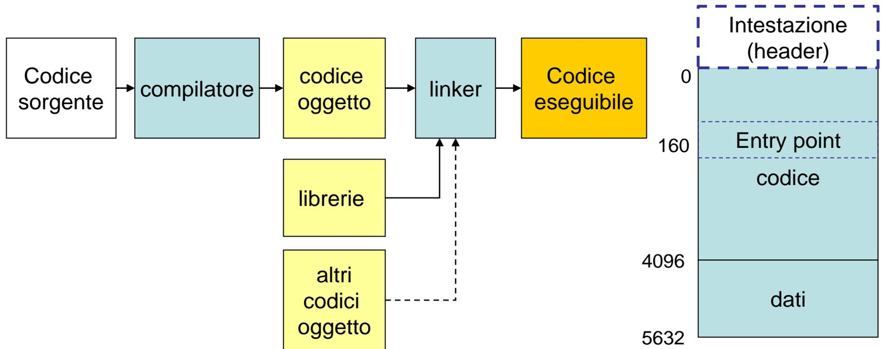
Lo **spazio virtuale di un processo**: memoria necessaria a contenere il suo codice, i dati su cui operare e lo stack (compreso l'heap).
